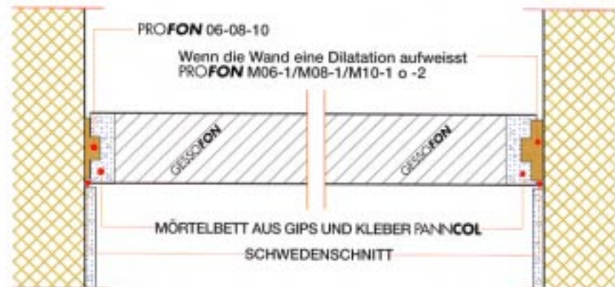
Anwendung zusammen mit Querschnitt 2-3-4 Die PROFON Profilstreifen darf man nur an die Wände kleben, und nicht an die GESSO FON PLATTEN
